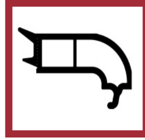
بروفيل لاقط زجاج مفرد ٦٠ + سحاب (٦mm) Single Glazing Bead 60 + SLIDING (6mm)
